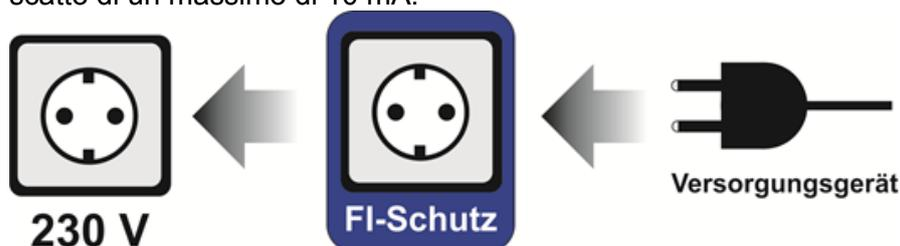
*Schema: Prestare attenzione alla successione: spina intermedia con protezione della persona FI nella presa di rete. Apparecchio di alimentazione nella connessione della spina intermedia con protezione della persona FI.*
